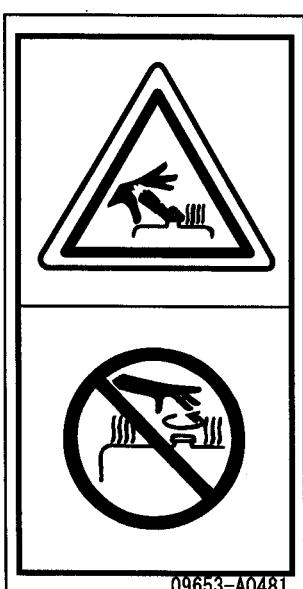
Знак указывает на опасность ожога горячей охлаждающей жидкостью или маслом, если открыть горячий радиатор или гидробак.
