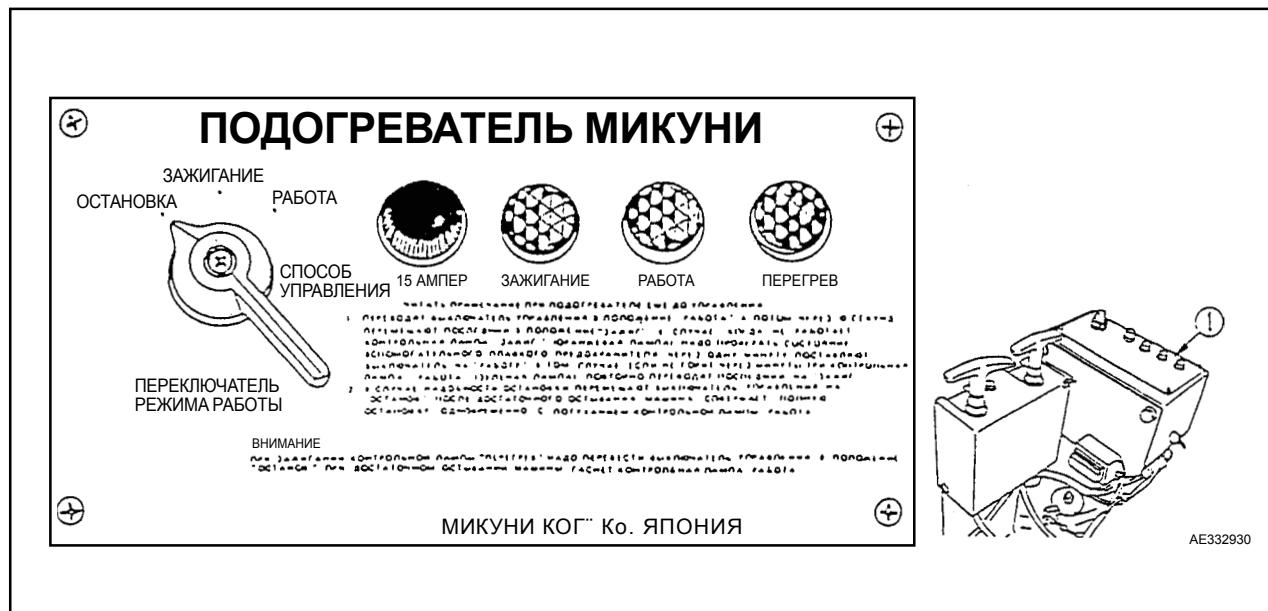
На панели управления подогревателя, смонтированной в задней части кабины, справа от сиденья оператора, размещены переключатель режима работы, вспомогательный плавкий предохранитель и три контрольные лампы.
