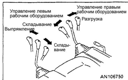
4. Поработайте рабочим оборудованием и рукоятью на полный ход в течение 5 минут, чередуя механизмы через каждые 30 секунд.
