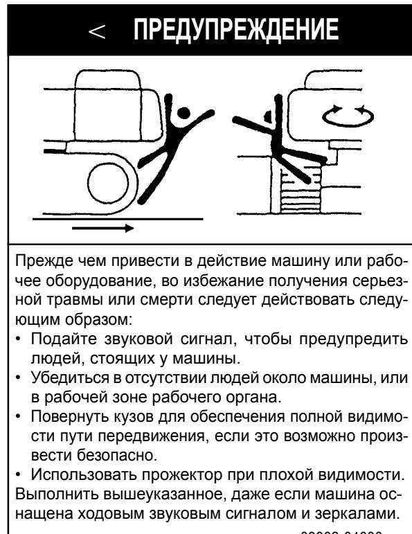
Прежде чем привести в действие машину или рабочее оборудование, во избежание получения серьезной травмы или смерти следует действовать следующим образом:
